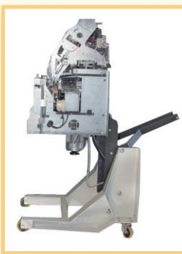
► Die Bindeaggregate sind mittels eines Transportwagens in nur 5 Minuten austauschbar. Dabei können Aggregate mit unterschiedlichen Bindedurchmessern (3/16, 1/4, 5/16 und 3/8) verwendet werden. Der vorher genutzte Einsatz wird entkoppelt und einfach gegen den Nächsten auf dem Wagen ausgetauscht.
