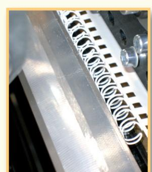
► La stazione di spiralatura è intercambiabile tramite carrello che permette di inserire i diversi kit (3/16", 1/4", 5/16", 3/8") in soli 5 minuti. Quando si deve effettuare un cambio di formato della spirale, tramite semplici movimenti, si "sgancia" dalla macchina il kit che si usava in precedenza e lo si sostituisce con il nuovo.
