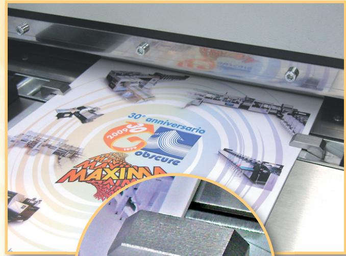
► L'operatore può facilmente centrare il materiale tra le pinze, usando la scala di punzonatura e del gancio, marcate sul piano d'acciaio.
